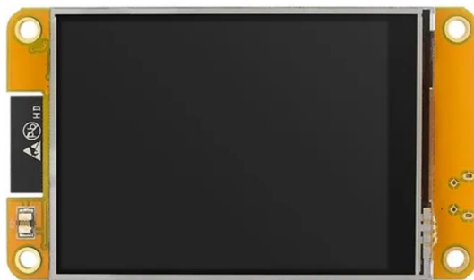
รูปที่ 2.4 AJ003 ESP32 Arduino LVGL WIFI&Bluetooth Development Board
