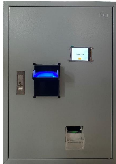
รูปที่ 3.1 โครงสร้างของเครื่องสแกนแลกเหรียญอัตโนมัติ
